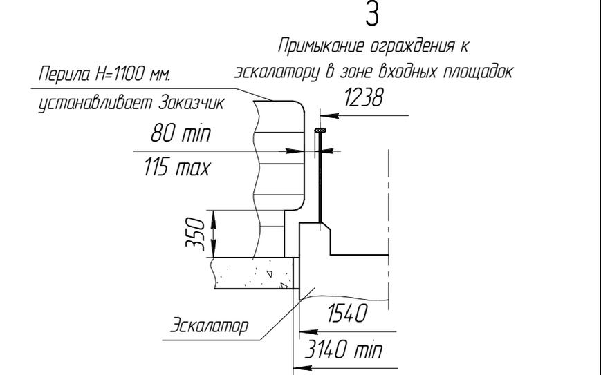
Для установки эскалатора необходимо предусмотреть возможность крепления монтажной оснастки к строительным конструкциям здания.
