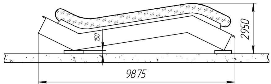
В случае установки эскалатора в строительную часть, отличную от изображенной на данном чертеже, необходимо обратиться в представительство ГК "ПЭЛК" для получения дополнительной информации.
